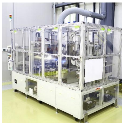
Automatisch schuivende galvaniseermachine met enkele productiestroom
