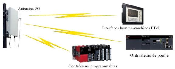
Équipement en cours de déploiement pour le test de démonstration du système 5G local
