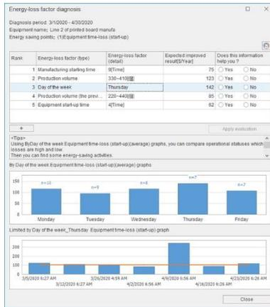
Logiciel compatible avec l'IA EcoAdviser pour le diagnostic et l'analyse des données liés à l'économie d'énergie
